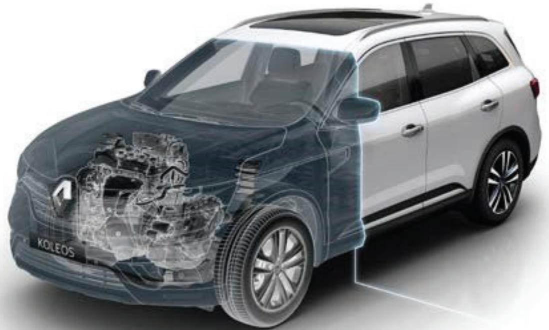
El motor de gama de 2,5L 170HP le confiere el poder de una rápida aceleración y una amplia capacidad de respuesta. La nueva caja de cambios X-Tronic combina la conducción flexible de la variación continua, el secuencial simulado de una caja de cambios automática y la disponibilidad de un modo manual para más sensaciones de conducción.
