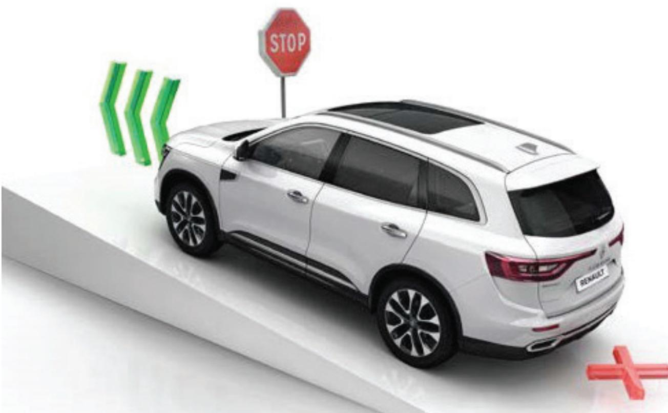
Además, los retrovisores con detección de punto muerto (BSW), avisan al conductor sobre la presencia de un objeto situado en el punto ciego de retroalimentación visual en el espejo correspondiente. Así mismo, el asistente de arranque en pendiente, ayuda al conductor a iniciar la marcha en superficies inclinadas, sin ningún movimiento hacia atrás y sin riesgo de que se apague el motor.
